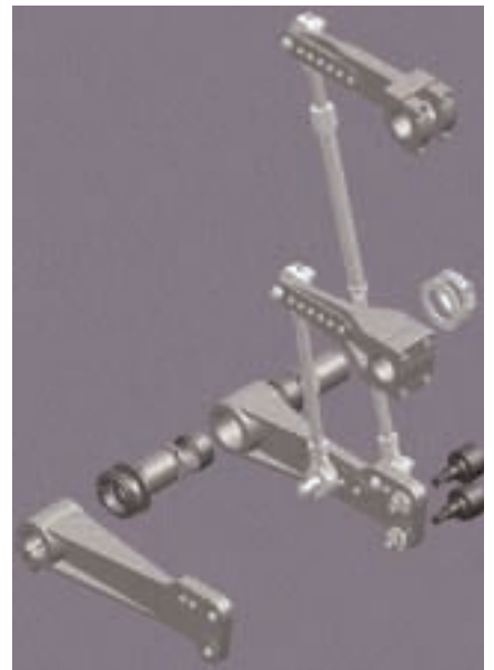
Modellierung und Festigkeitsanalyse mit CATIA; z.B. diese Hebelanordnung einer Wirkmaschine
